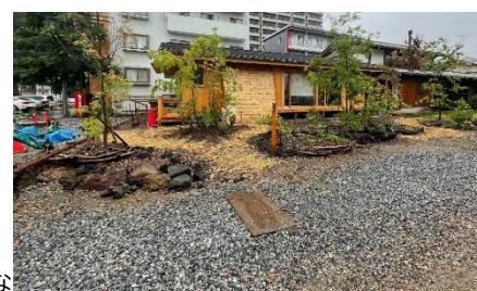
→（2022.7.12～13の事例）一旦は足首まで浸水するも一切土や、養生に敷いた稻藁や落ち葉も流れ出ず、雨が止むと同時に雨水は地下に浸透した
