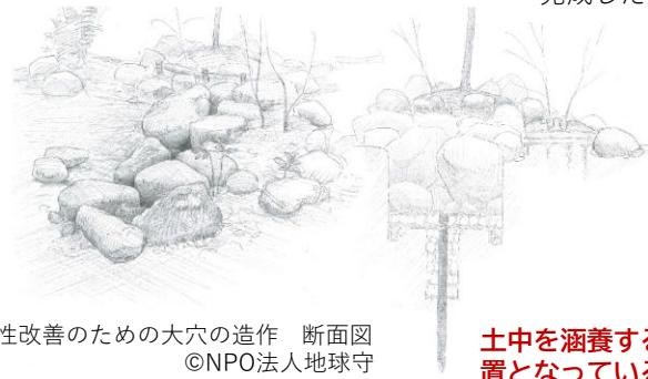
浸透性改善のための大穴の造作 断面図
