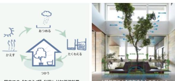
本計画において屋内空間にハイドロカルチャー（水耕栽培）による空気浄化システム※2を実装。今後は雨水を活用した灌水やトイレへの中水利用など、居住空間を含めた技術開発を行い、常時・災害時・夏期における多様な水循環提案によりグリーンインフラの活用を促進していく。
