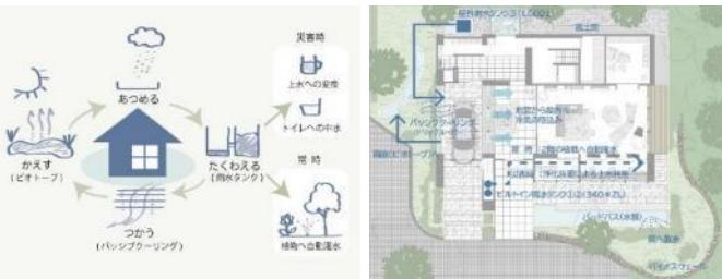
屋根で集めた雨水はビルトイン雨水タンク①②と屋外タンク③に貯水。常時バルコニー内の植栽へタイマーで自動灌水を行い災害（断水）時には浄化装置により上水に変換が可能。夏期においてはパッシブクーリングシステムへ通水し気象情報にあわせて蒸散冷却を行い、使用した水はピオトープへ2次貯留し生態系へ。また浸水を防ぐ塀をバードバス（水盤）とすることで生態系の保全に寄与しながら周囲への雨水流出抑制や災害時・渇水時の水資源を確保することができる。
