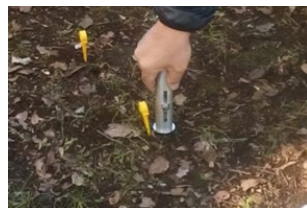
写真2 山中式土壌硬度計
