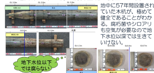
図 丸太は地下水位以下では腐朽しない
