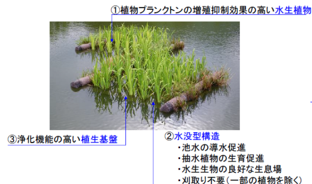
図 水質浄化に使用する植生浮島
