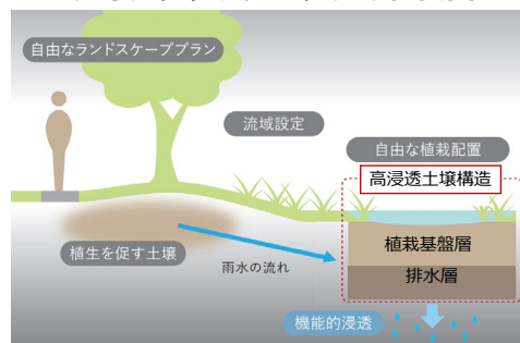
浄水場発生土を リサイクルした 植栽基盤層用資材
