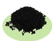
浄水場発生土を リサイクルした 植栽基盤層用資材
