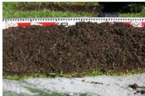
図 芝生用耐圧基盤の生育状況 根の伸長が良好
