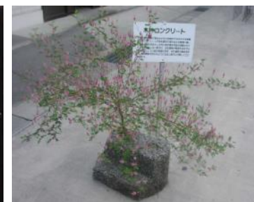
写真 木片ブロック
