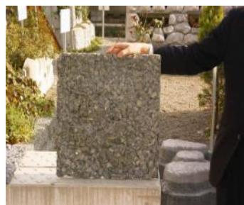
写真 木片コンクリート
