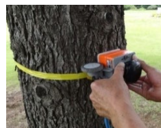
レーダによる診断の状況
