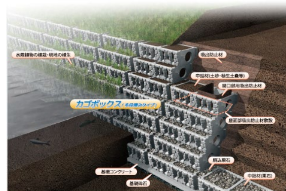
※開口部及び底面吐出防止材は、土砂を充填する場合に設置します。
