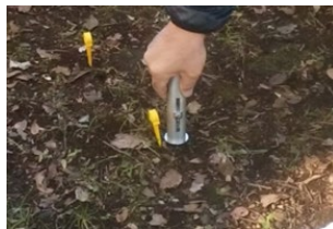
写真2 山中式土壌硬度計
