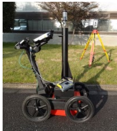
写真 自動追尾型TSと同期したGPR
