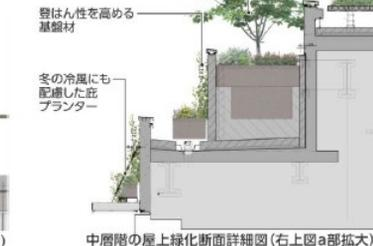
中層階の屋上緑化断面詳細図（右上図a部拡大）
