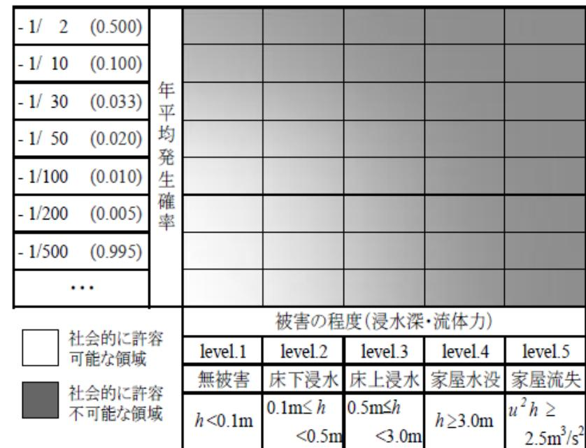
図 評価対象地点の水害リスクマトリクス(宅地利用の場合)
