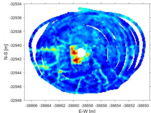
グラフ 深度0~0.3mにおける測定データの振幅を積分したもの
