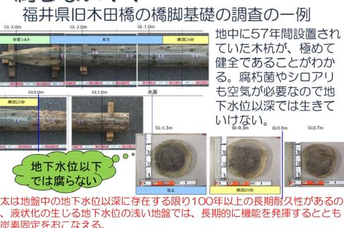
図 丸太は地下水位以深では腐朽しない
