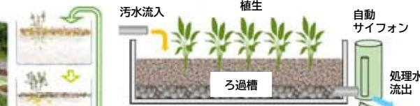
図 タイダル式水質浄化システム
