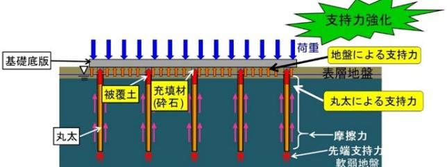
図 LP-SoC工法の原理
