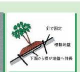
②ユニット苗は、主に切土のり面植栽用として、NEXCO3社が特許を保有する座布団状の袋（ユニット袋）で育成した苗木。袋の底部は不織布で作られ、根が外に伸長できるので、植え穴を掘らずに釘等で固定するだけで、植え付けることができる。
