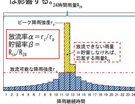
図 放流率 $\alpha$ 及び貯留率 $\beta$ の考え方
