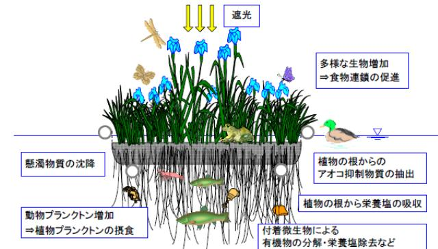
図 植生浮島による浄化作用
