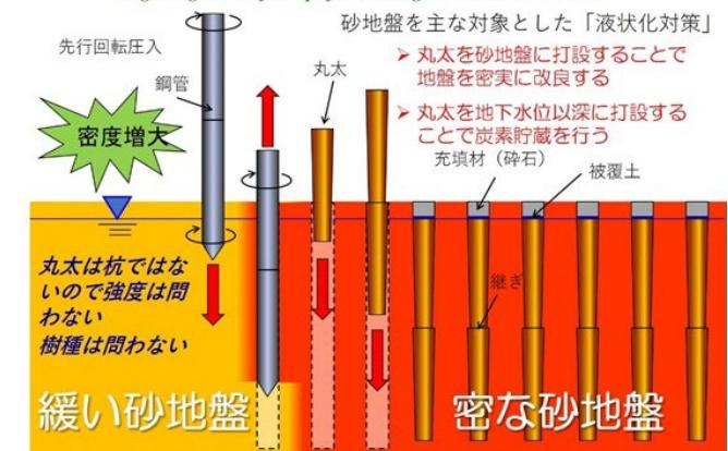
図 LP-LiC工法の原理
