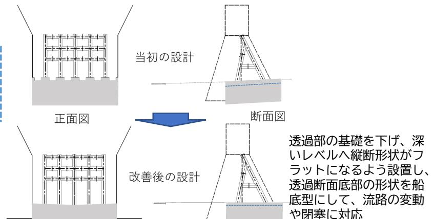
図 透過型砂防堰堤のアドバイスに基づく設計変更例
