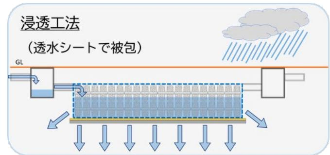
図 浸透工法のしくみ
