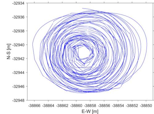
グラフ 根系測定時のGPRの軌跡
