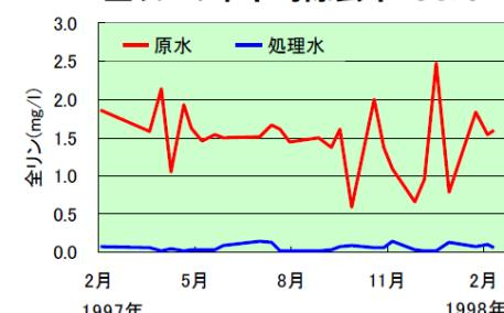
図 水質浄化性能（処理水量：100l/m<sup>2</sup>/日）
