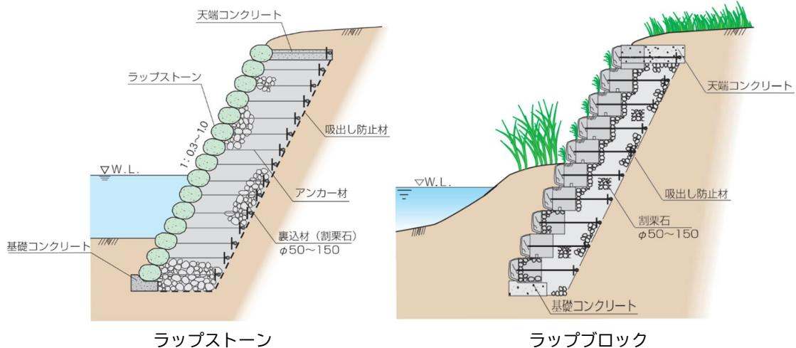
図 アンカー式空積工法断面図
