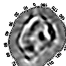
左図 幹内部の断面図の例
