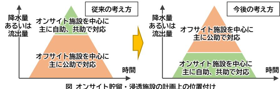
図 オンサイト貯留・浸透施設の計画上の位置付け
