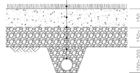
図 芝生用耐圧基盤土壤断面図
