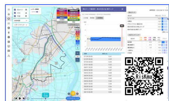
タンク水位の見える化に挑戦している「雨水RisKma(リスクマ)」システム
